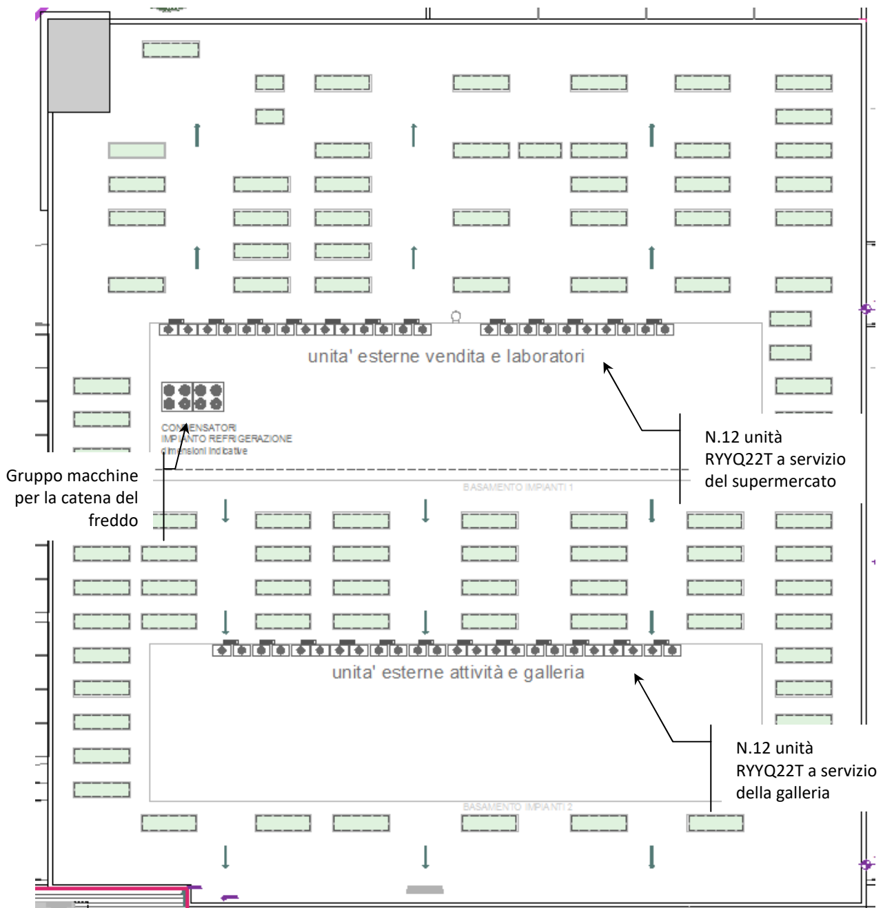
Copertura galleria. Posizionamento impianti a servizio di supermercato e galleria commerciale
